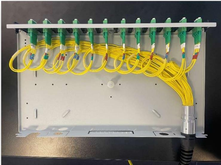
*Abbildung 8: In einem Patchpanel aufgelegtes beidseitig vorkonfiguriertes 48-Faserkabel mit LC/APC-Steckern für die Querverkabelung*
